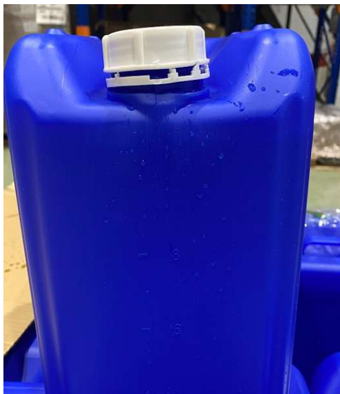
Нарушено страховочное кольцо.
